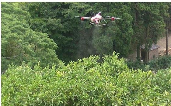
写真1 ドローンが樹上で旋回しながら薬剤散布する様子
